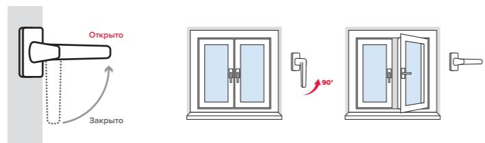
Для перевода створки из закрытого положение в откидное (поворот створки относительно нижней горизонтальной оси, положение «Откинуто») ручку поворачивают вертикально на 180 градусов вверх, затем, потянув за ручку, поворачивают створку относительно нижней горизонтальной оси на заданный изготовителем угол (не более 10 градусов) (откидной режим).
